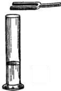
298-сүүрет. Сүүдың үстиндеги ҳаўаның бағанасын резонансқа алып келиў.
